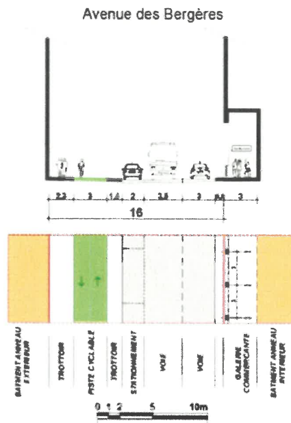
Illustration 29 : Coupe transversale de l'avenue des Bergères (Etude d'impact initiale, 2012)
