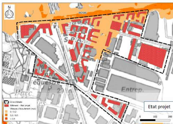
Figure 53 : Comparaison des vitesses d'écoulement entre l'état actuel et l'état projet (Source : Rapport n°112010 version A, Antea Group, Juillet 2021)
