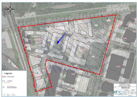
Figure 16 Carte piézométrique et sens d'écoulement de la nappe superficielle des sables de Beauchamp (Source : Rapport n°1023965A de ICF)
