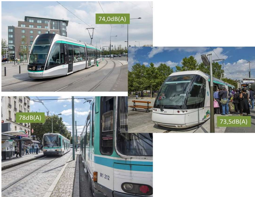
Figure 10 : Niveaux sonores, en dB(A), de divers tramways circulant, à 40km/h et à 7,5m de l'axe de la voie (NF EN ISO 3095).
