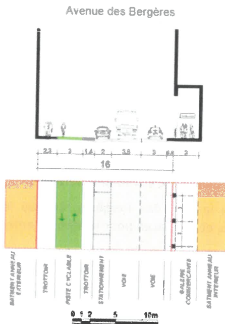
Illustration 29 : Coupe transversale de l'avenue des Bergères (Étude d'impact initiale, 2012)
