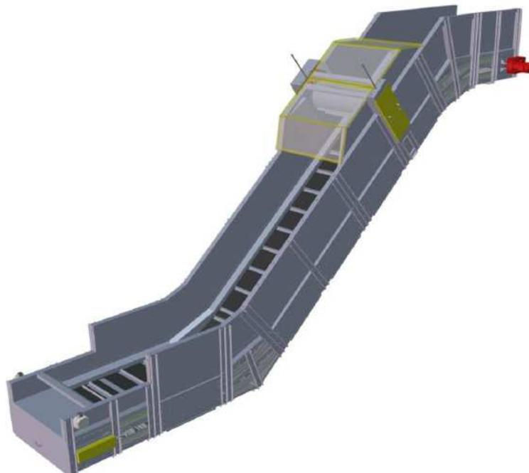
Figure 14 : Représentation de l'élévateur du centre de tri Paris XVII (source : CNIM)
